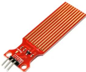
Sensor De Agua Lluvia Sensor Nivel De Líquido Profundidad
